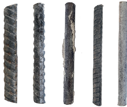
Rys. 4. Widok powierzchni wybranych prętów zbrojeniowych wyjętych z rdzeni betonowych, po ich zmiążdżeniu w maszynie wytrzymałościowej
